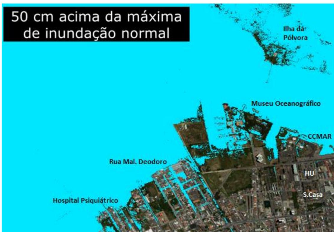
Figura 02 – Simulação da inundação nas ruas de Rio Grande, considerando o nível do linígrafo instalado no CCMAR
