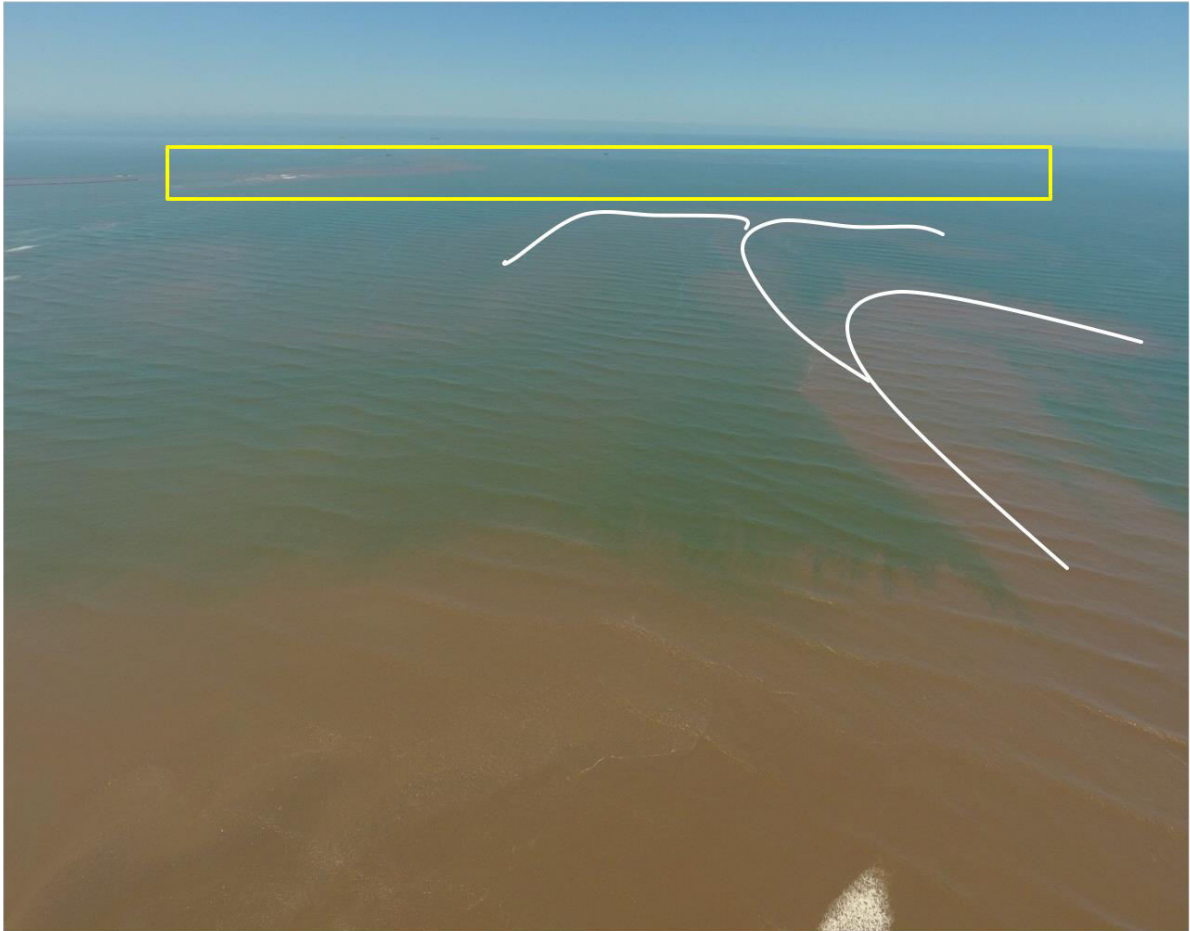
Figura 8 – Foto aérea de 08/12/2018 mostrando pluma de sedimentos na porção próxima da Praia do Cassino. As linhas brancas mostram que o fluxo é possivelmente dirigido da praia para o oceano, com a formação típica de “cogumelos”. O retângulo amarelo mostra uma extensa área sem a presença de pluma de sedimentos. Adaptado da foto obtida pelo “Movimento SOS-Cassino”.
